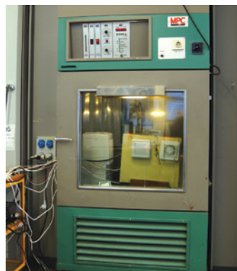
Klimatická komora pro testování ventilátorů při extrémních hodnotách teplot, vlhkosti, slanosti prostředí a UV záření
