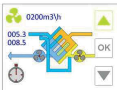
změna otáček ventilátorů pomocí nastavení průtoku
