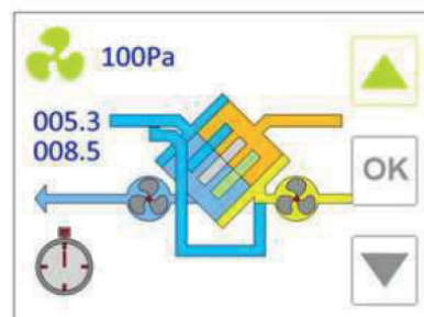
změna otáček ventilátorů pomocí nastavení tlaku
